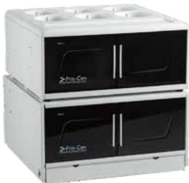
高效液相色谱仪包含一套全 PEEK 流路的高压离子色谱泵、一套在线形态消解系统、一套柱后氢化物发生系统（含气液分离装置）、一套色谱工作站，以及与 AFS 和 ICPMS 联机的接口等等。独特的柱后反应设计可以节省 80% 以上的试剂（盐酸和硼氢化钾），既方便又环保。该仪器和 AFS 或者 ICPMS 联用，可以实现 As、Hg、Se、Sb、Cr、Br、Sn、Fe、Mn 等多种元素的形态分析。此外，该仪器可以搭配 ONLY WATER KIT 的形态分析试剂盒，用户只需加水即可完成无机砷等元素形态分析。
