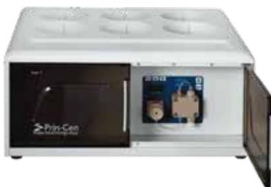
元素形态分析常用的流动相为缓冲盐溶液，样品也通常用酸 / 碱液提取，因此对 HPLC 的耐腐蚀性提出更高的要求。Prin-Cen 将 HPLC 的流路从常用的不锈钢材质全部改成了 PEEK 材质（泵头、单向阀、压力传感器、管路、流动相过滤头等），从而大大提高了 HPLC 的耐腐蚀性，更适应元素形态分析。
