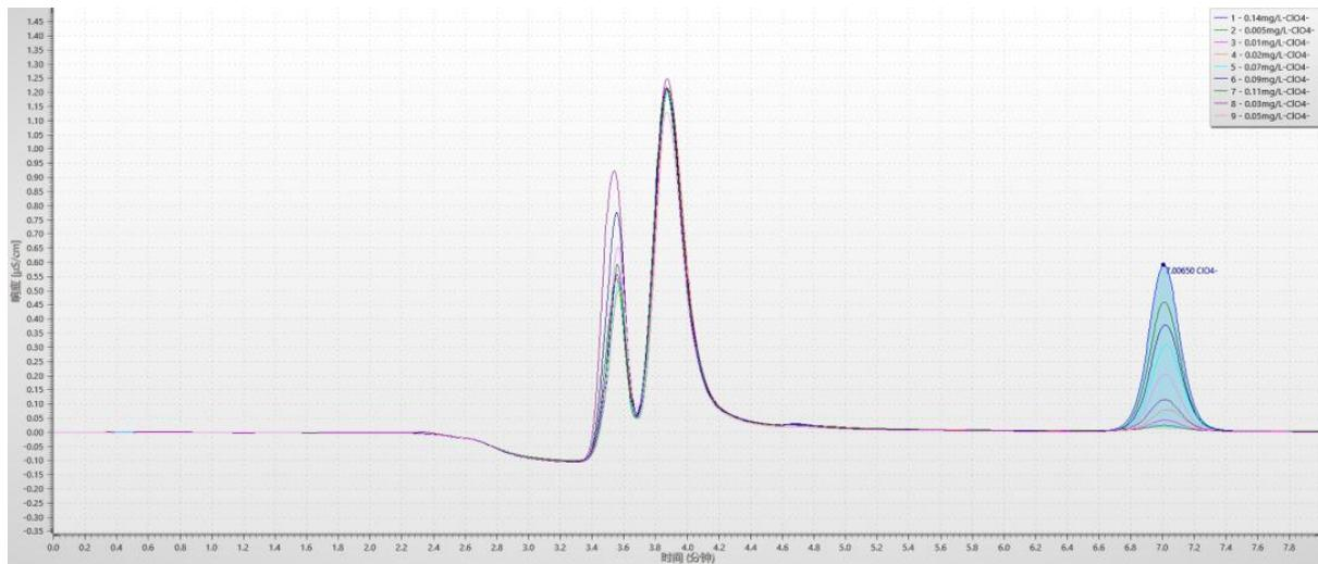
(3) 标准溶液 0.005mg/L-ClO<sub>4</sub><sup>-</sup>图谱:
